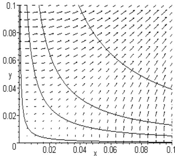
Рис. 3. Линии тока при  $Re \rightarrow \infty$
