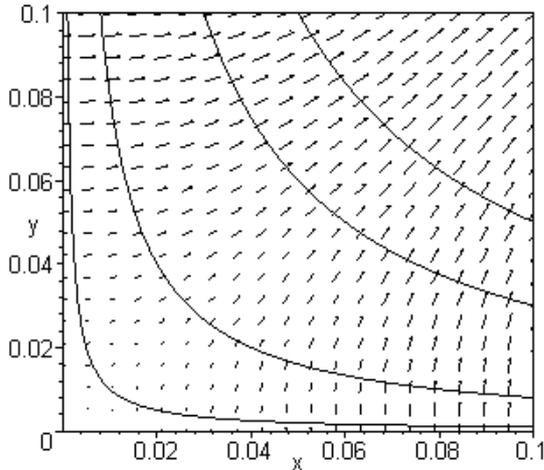
Рис. 4. Линии тока при  $Re \rightarrow 0$
